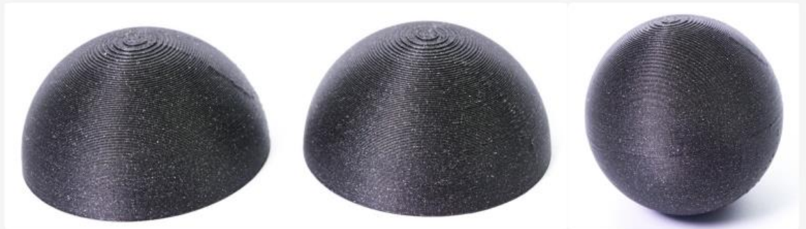
Drukowanie kuli przeciętej na dwie półkule, które zostaną sklejone po wydruku.
